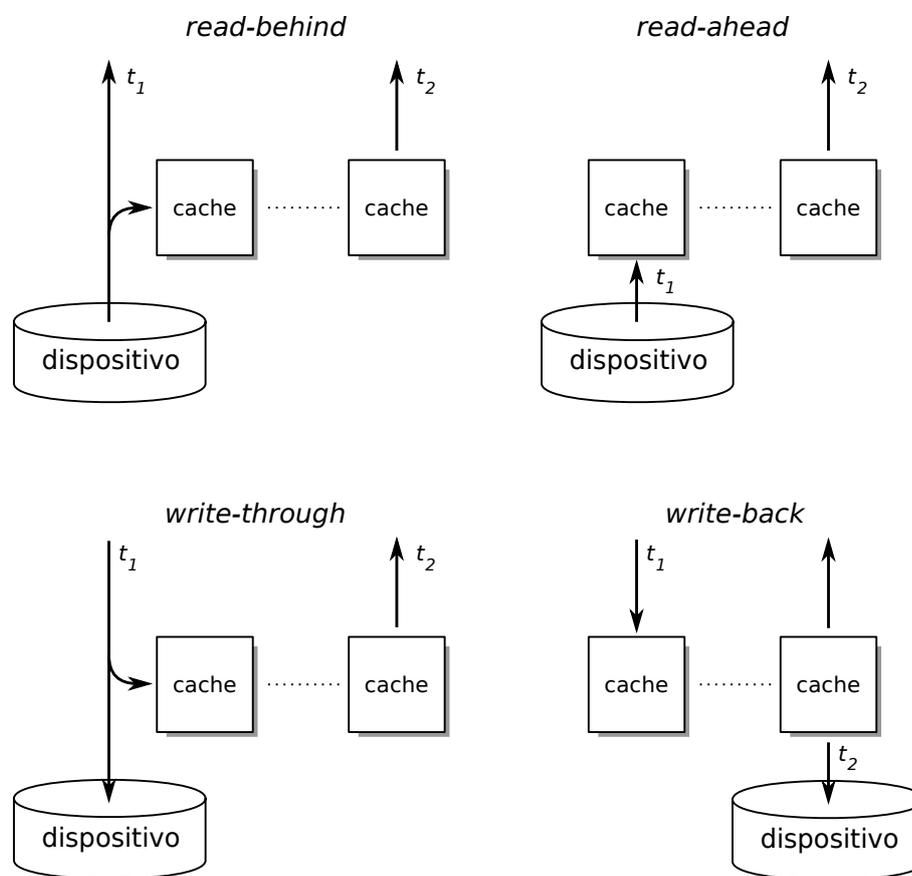
Figura 13: Estratégias de *caching* de blocos ( $t_1$  e  $t_2$  indicam dois instantes de tempo).
