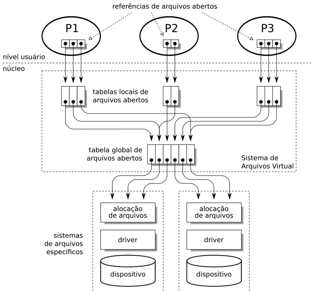
Figura 21: Estruturas de controle de arquivos abertos em um núcleo UNIX.
